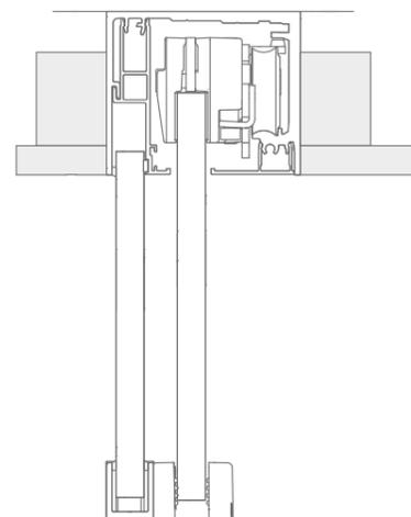
\*Das verwendete Glas muss immer nach EN 12150 gehärtet und sicher sein
