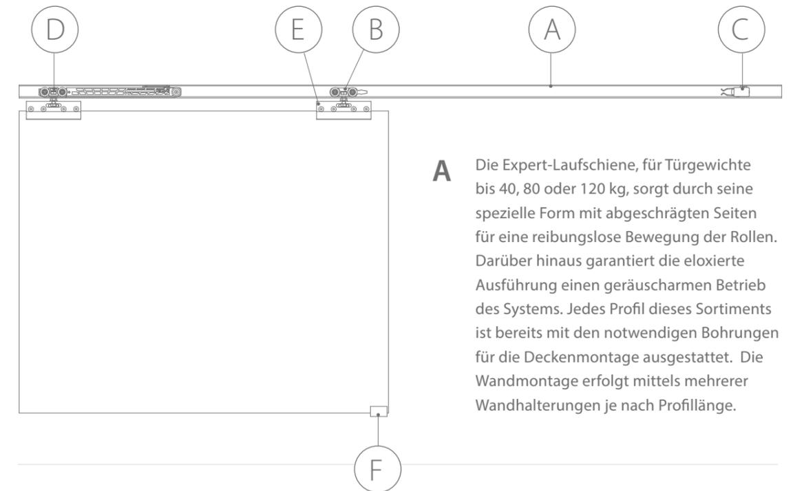
**A** Die Expert-Laufschiene, für Türgewichte bis 40, 80 oder 120 kg, sorgt durch seine spezielle Form mit abgeschrägten Seiten für eine reibungslose Bewegung der Rollen. Darüber hinaus garantiert die eloxierte Ausführung einen geräuscharmen Betrieb des Systems. Jedes Profil dieses Sortiments ist bereits mit den notwendigen Bohrungen für die Deckenmontage ausgestattet. Die Wandmontage erfolgt mittels mehrerer Wandhalterungen je nach Profillänge.
