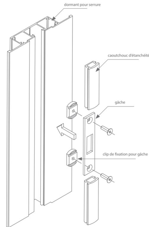
Le dormant pour serrure convient pour des portes en bois et en verre. En combinaison avec une porte en bois, le caoutchouc d'étanchéité gris peut être interrompu pour une gâche à utiliser avec une serrure à crochet. Ceci convient également pour des portes toute hauteur. Le profil peut être coupé en fonction de la hauteur de porte
