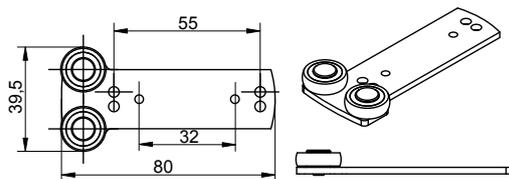
**5 Joint de guidage autocollant** **DK0.419.\*\*\***
