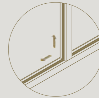
2D regelbaar voor strakke aflijning met vloer en plafond
