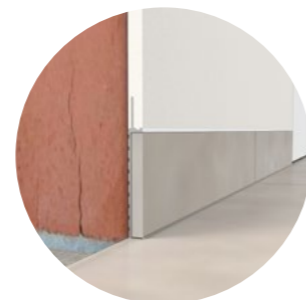
Verzonken plint droogbouw (type 2) of verzonken plint natbouw (type 3) met afwerkingsplint in hetzelfde materiaal als de vloer
